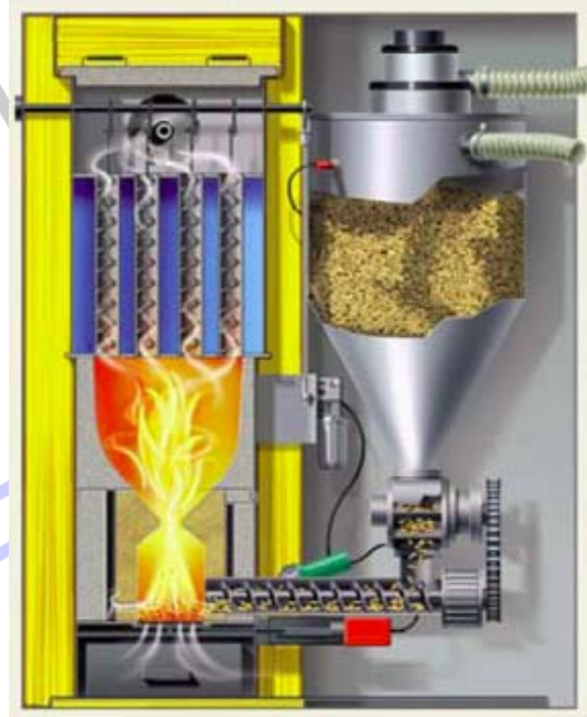
Şekil 1 Otomatik beslemeli pelet yakıtlı bir kazan. Kaynak: http://www.techline.linak.com/corporate/imagelibrary/casestories/Pellet-oven-1.jpg (13 Kasım 2009)
